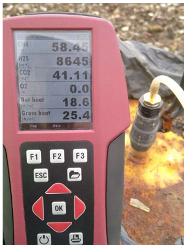
Fot. 9 Pomiar składu gazu w studni gazowej
