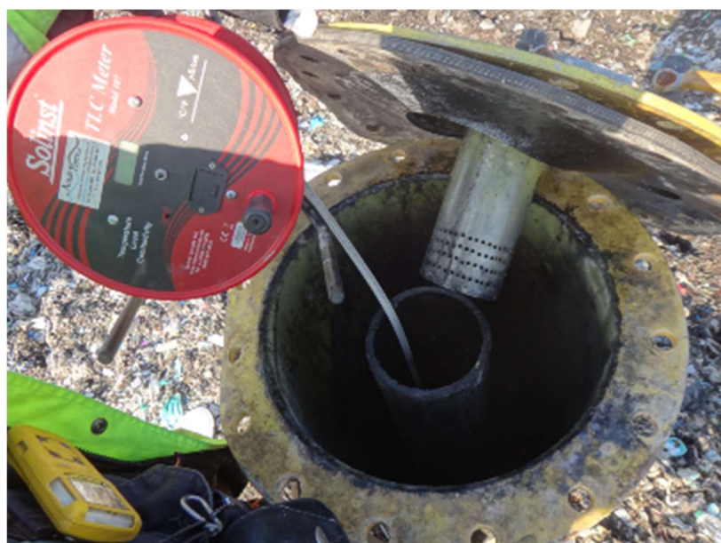
Fot. 12 Pomiar głębokości studni i poziomu odcieków
