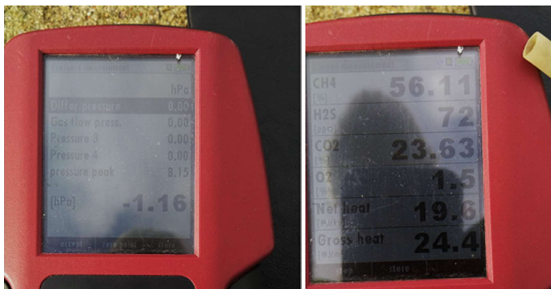
Fot. 22 Parametry gazu w studni gazowej S-13
