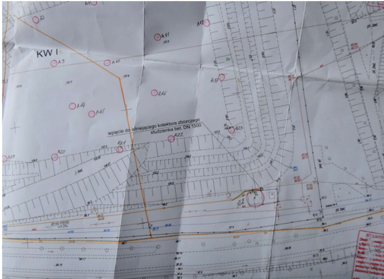
Rysunek 15 Lokalizacja studzienki z wpięciem do kolektora gazowego DN160 z kwatery I
