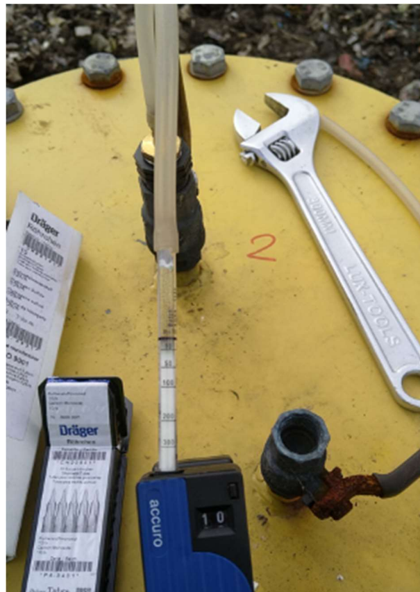
Fot. 11 Pomiar stężenia tlenu węgla przy pomocy rurki Draegera
