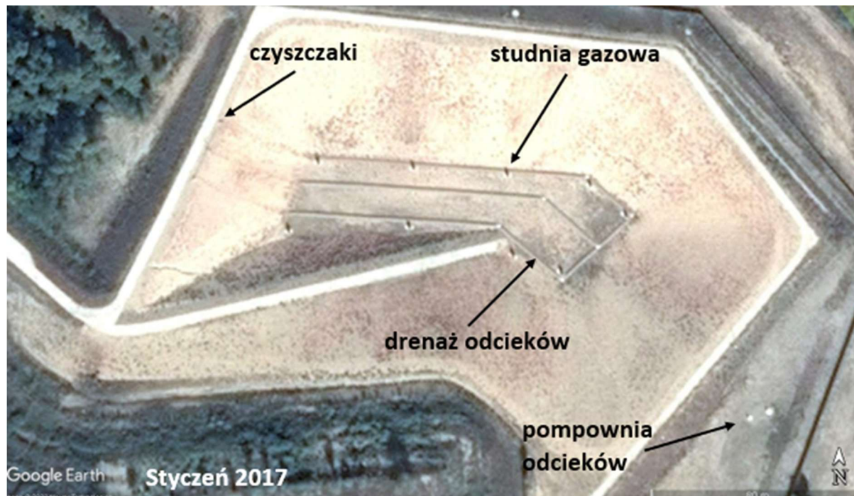
Rysunek 1 Lokalizacja infrastruktury gazowej i odciekowej na kwaterze 03 (Google Earth)
